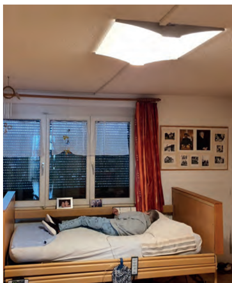
Die Beleuchtung im Testaufbau wurde dem natürlichen Tagesgang der Sonne nachempfunden. Zur Stabilisierung der inneren Uhr und als positive Auswirkung auf den Körper.
